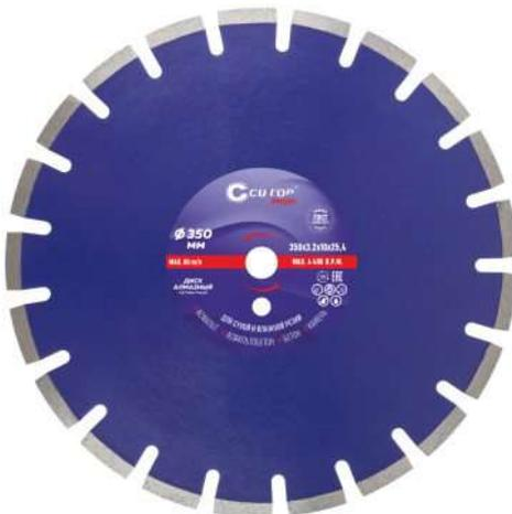
Промышленный алмазный диск Cutop Profi предназначен для сухой и мокрой резки асфальта, асфальтобетона и других высокоабразивных материалов. Используется в швонарезчиках и бензорезах. Благодаря широкому алмазному слою, обеспечивается быстрое резание и долгий срок службы. Режущая кромка высотой 10 мм состоит из сегментов, изготовленных с применением высококачественных технических алмазов повышенной прочности, приваренных методом пайки к телу диска.
