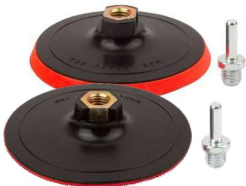
Насадка предназначена для УШМ и дрелей. Применяется для проведения шлифовальных работ совместно с алмазными гибкими шлифовальными кругами (АГШК) на ворсовой основе. В комплекте поставляется переходник с резьбы М14 на цилиндрический хвостовик для крепления оснастки в патроне электродрели. Материал: инструментальная сталь, пластик (полиуретановая прокладка для мягкой). Упаковка: п/э пакет с картонным подвесом.
