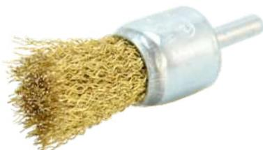
Щетка для дрели, форма «Кистеобразная» со шпилькой, 25 мм, витая латунированная проволока 0,3 мм. Предназначена для мягкой качественной зачистки различных металлических и деревянных поверхностей, снятия ржавчины, удаления лакокрасочных покрытий и других загрязнений. Отлично подходит для обработки больших плоскостей. Такая форма оптимально подходит для обработки углов, пазов, изгибов и других труднодоступных участков. Упаковка: блистер.
