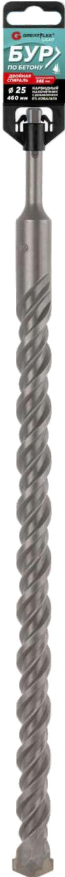
Бур по бетону GREATFLEX LIGHT для профессионального использования. Карбидный наконечник повышенной плотности с добавлением кобальта 6% гарантирует длительную работу бура без изменения диаметра.
