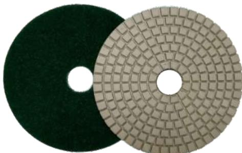
Круг предназначен для УШМ с регулировкой оборотов в диапазоне от 2500 до 4500 об/мин. Применяется для шлифования и полировки мрамора, гранита, керамогранита и других изделий из натурального и искусственного камня с использованием воды. Круг имеет алмазное напыление и изготовлен на гибкой основе. Крепится при помощи липучки на специальную насадку. Материал: полимерная связка, алмазная фракция, ворсовая основа. Упаковка: подвесной пакет.
